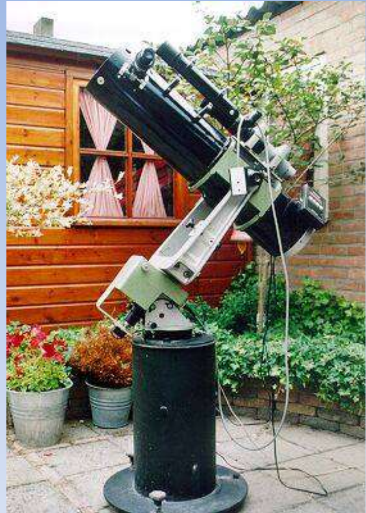
150/900mm Newton (Astrotechniek) - vorkmontering - aandrijving op beide assen - geschikt voor autoguiding
